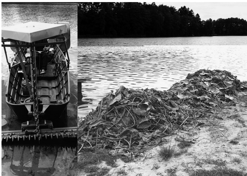
Ryc. 5. Kosiarka pływająca wykorzystana do przycinania roślinności wodnej oraz biomasa roślinna usuwana z jeziora w trakcie wykonywanych prac
