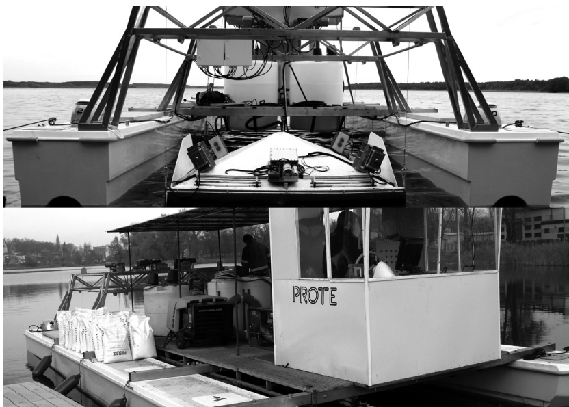
Ryc. 1. Dwumodułowa jednostka pływająca PROTEUS. Widok na moduł podwodny (góra) oraz powierzchniowy (dół)
